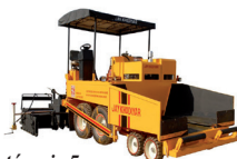
Catégorie 5 : engins de finition (finisher, pulvi- mixeurs, coffrage glissant, ...)
